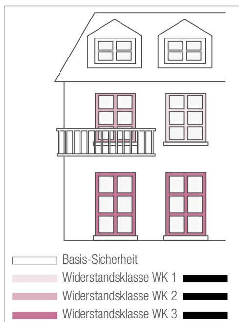
Spezielle Sicherheitskomponenten für individuelle Einbruchhemmung.
